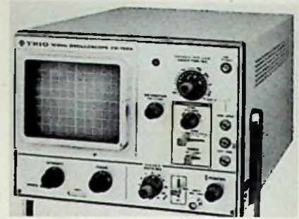
Marke: Trilo Modell: CS-1559 Schirmgröße: 8 cm x 10 cm Y-Grenzfrequenz: 10 MHz Y-Koeff.: 10 mV/T ... 20 V/T Zeit-Koeff.: 1 µs/T ... 0,5 s/T Dehnung: 5fach Trigger: auto, frei, +/-, TV Eichquelle eingeb.: ja Gewicht: 8 kg Preisbeobachtung: etwa 850 DM
