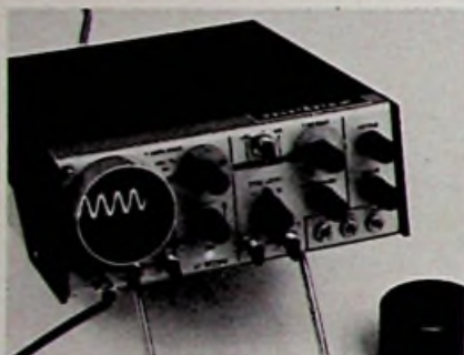
Marke: Metrix Modell: OS 1010 Schirmgröße: 2 cm x 2,5 cm Y-Grenzfrequenz: 10 MHz Y-Koeff.: 10 mV/T ... 50 V/T Zeit-Koeff.: 1 µs/T ... 1 s/T Dehnung: nein Trigger: frei, auto, +/- Eichquelle eingeb.: ja Gewicht: 1,65 kg mit Akku Preisbeobachtung: etwa 1500 DM mit Akku
