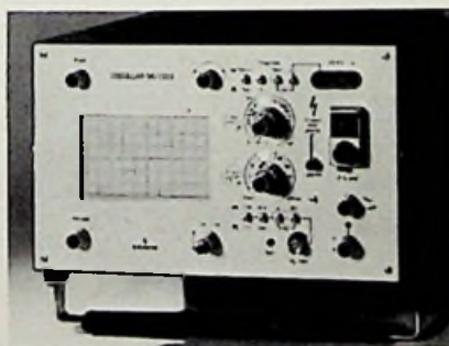
Marke: Siemens Modell: Oscillarzet MO 7222 Schirmgröße: 6 cm x 10 cm Y-Grenzfrequenz: 10 MHz Y-Koeff.: 5 mV/T ... 20 V/T Zeit-Koeff.: 0,3 µs/T ... 30 ms/T Dehnung: nein Trigger: auto, frei, +/- Eichquelle eingeb.: ja Gewicht: 7,6 kg Preisbeobachtung: etwa 3500 DM
