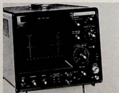
Marke: B & K Precision Modell: 1465-D Schirmgröße: 8 cm x 10 cm Y-Grenzfrequenz: 10 MHz Y-Koeff.: 10 mV/T . . . 20 V/T Zeit-Koeff.: 1 µs/T . . . 20 ms/T Dehnung: 5fach Trigger: auto, frei, +/-, TV Eichquelle eingeb.: ja Gewicht: 10,5 kg Preisbeobachtung: etwa 1400 DM
