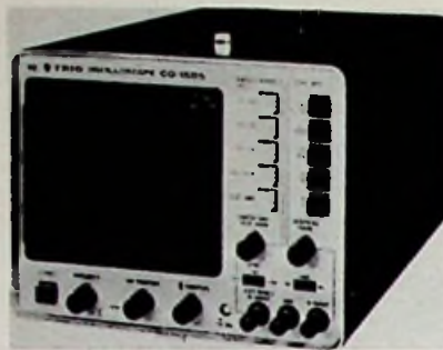
Marke: Trilo Modell: CO-1505 Schirmgröße: 8 cm x 10 cm Y-Grenzfrequenz: 1,5 MHz Y-Koeff.: 20 mV/T ... 20 V/T Zeit-Koeff.: — Dehnung: — Trigger: nein, Synchron. 10 Hz ... 100 kHz Eichquelle eingeb.: ja Gewicht: 5,2 kg Preisbeobachtung: etwa 600 DM
