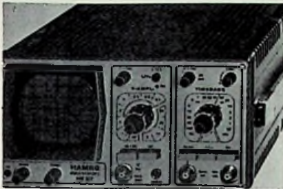
Marke Hameg Modell: HM 307 Schirmgröße: 4 cm x 6 cm Y-Grenzfrequenz: 10 MHz Y-Koeff.: 5 mV/T ... 20 V/T Zeit-Koeff.: 0,5 µs/T ... 0,2 s/T Dehnung: 5fach Trigger: auto, frei, +/-, TV Eichquelle eingeb.: ja Gewicht: 4,6 kg Preisbeobachtung: etwa 600 DM; Bausatz 470 DM
