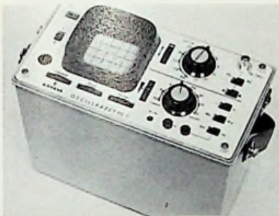
Marke: Siemens Modell: Oscillarzet 05 T Schirmgröße: 4 cm x 5 cm Y-Grenzfrequenz: 5 MHz Y-Koeff.: 10 mV/T ... 50 V/T Zeit-Koeff.: 2 µs/T ... 100 ms/T Dehnung: 5fach Trigger: auto, frei, +/- Eichquelle eingeb.: nein Gewicht: mit Akku 4,5 kg Preisbeobachtung: etwa 2200 DM mit Akku
