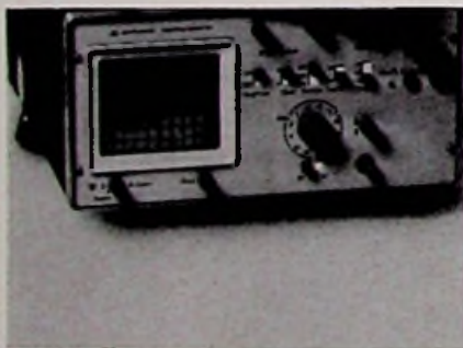
Marke: Advance Instruments Modell: OS 140 Schirmgröße: 8 cm x 6,4 cm Y-Grenzfrequenz: 10 MHz Y-Koeff.: 5 mV/T . . . 20 V/T Zeit-Koeff.: 1 µs/T . . . 0,1 s/T Dehnung: 2fach und 5fach Trigger: frei, +/-, TV Eichquelle eingeb.: nein Gewicht: 5 kg Preisbeobachtung: etwa 750 DM
