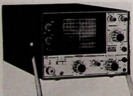
Marke: Metrix Modell: OX 318 A Schirmgröße: 5,6 cm x 7 cm Y-Grenzfrequenz: 15 MHz Y-Koeff.: 10 mV/T ... 50 V/T Zeit-Koeff.: 0,5 µs/T ... 0,5 s/T Dehnung: 5fach Trigger: auto, frei, +/-, TV Eichquelle eingeb.: ja Gewicht: 5,3 kg Preisbeobachtung: etwa 2000 DM
