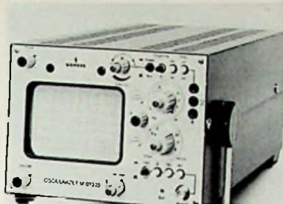
Marke: Siemens Modell: Oscillar MO 7223 Schirmgröße: 6 cm x 10 cm Y-Grenzfrequenz: 10 MHz Y-Koeff.: 5 mV/T ... 20 V/T Zeit-Koeff.: 0,2 µs/T ... 1 s/T Dehnung: nein Trigger: auto, frei, +/- Eichquelle eingeb.: ja Gewicht: 11,6 kg Preisbeobachtung: etwa 8000 DM
