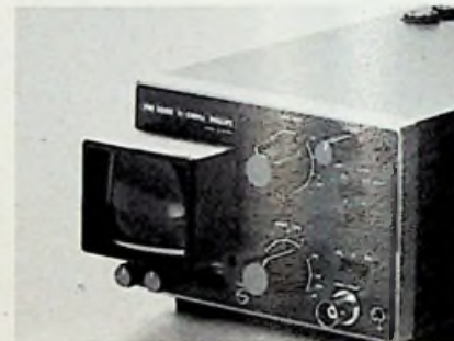
Marke: Philips Modell: PM 3000 Schirmgröße: 1,8 cm x 2,7 cm (Lupe 1,5fach) Y-Grenzfrequenz: 5 MHz Y-Koeff.: 10 mV/T ... 5 V/T Zeit-Koeff.: 0,3 µs/T ... 0,1 s/T Dehnung: 10fach Trigger: auto, frei, +/- Eichquelle eingeb.: nein Gewicht: 1,6 kg; mit Akku 1,8 kg Preisbeobachtung: etwa 1700 DM
