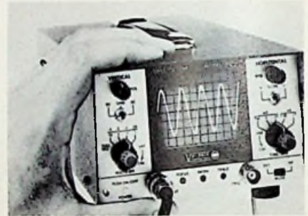
Marke: VU-Data Modell: PS-121 A Schirmgröße: 4 cm x 5 cm Y-Grenzfrequenz: 5 MHz Y-Koeff.: 50 mV/T ... 10 V/T Zeit-Koeff.: 1 µs/T ... 10 ms/T Dehnung: keine Angaben Trigger: auto, frei, +/- Eichquelle eingeb.: keine Angaben Gewicht: 2,3 kg Preisbeobachtung: etwa 1700 DM
