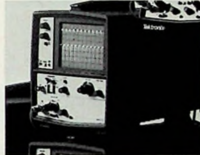
Marke: Tektronix Modell: T 921 Schirmgröße: 8 cm x 10 cm Y-Grenzfrequenz: 15 MHz Y-Koeff.: 2 mV/T ... 10 V/T Zeit-Koeff.: 0,2 µs/T ... 0,5 s/T Dehnung: 10fach Trigger: auto, frei, +/-, TV Eichquelle eingeb.: ja Gewicht: 7 kg Preisbeobachtung: etwa 1900 DM
