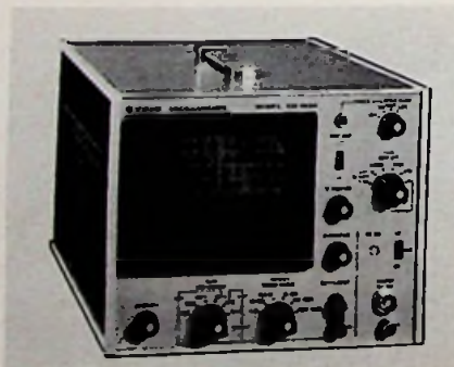
Marke: Trilo Modell: CS-1351 Schirmgröße: 4 cm x 6 cm Y-Grenzfrequenz: 10 MHz Y-Koeff.: 10 mV/T ... 20 V/T Zeit-Koeff.: 0,5 µs/T ... 0,5 s/T Dehnung: 5fach Trigger: auto, frei, +/-, TV Eichquelle eingeb.: ja Gewicht: 5,5 kg Preisbeobachtung: etwa 850 DM
