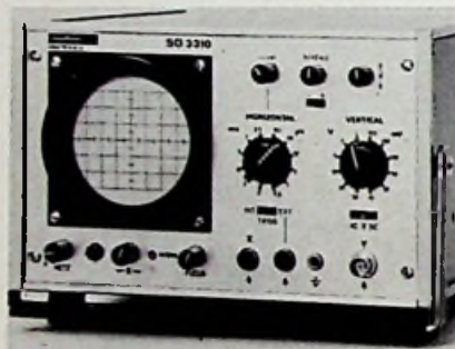
Marke: Nordmende electronics Modell: SO 3310 Schirmgröße: 5 cm x 6 cm Y-Grenzfrequenz: 10 MHz Y-Koeff.: 10 mV/T ... 50 V/T Zeit-Koeff.: 0,5 µs/T ... 5 ms/T Dehnung: bis 8fach Trigger: frei, auto, +/-, TV Eichquelle eingeb.: nein Gewicht: 4 kg Preisbeobachtung: etwa 700 DM
