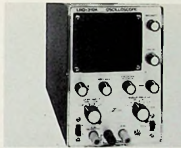
Marke: Leader Modell: LBO-310 A Schirmgröße: 6 cm x 4,8 cm Y-Grenzfrequenz: 4 MHz Y-Koeff.: 20 mV/T ... 2 V/T Zeit-Koeff.: — Dehnung: nein Trigger: nein, Synchron. 10 Hz ... 100 kHz Eichquelle eingeb.: nein Gewicht: 4,5 kg Preisbeobachtung: etwa 500 DM
