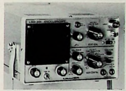
Marke: Leader Modell: LBO-301 Schirmgröße: 6 cm x 4,8 cm Y-Grenzfrequenz: 5 MHz Y-Koeff.: 10 mV/T ... 5 V/T Zeit-Koeff.: 2 µs/T ... 0,2 s/T Dehnung: 5fach Trigger: auto, frei, +/- Eichquelle eingeb.: ja Gewicht: 4 kg Preisbeobachtung: etwa 1300 DM
